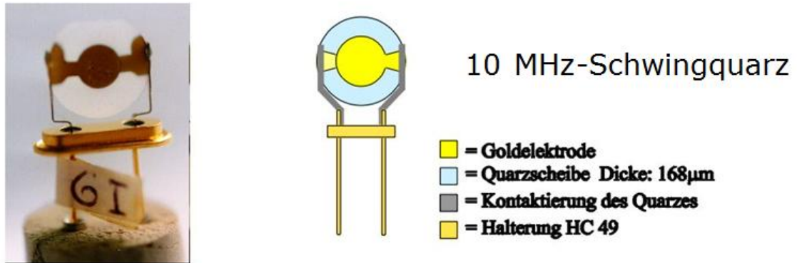
Abb. 11-36 Schwingquarz bei geöffnetem Gehäuse
