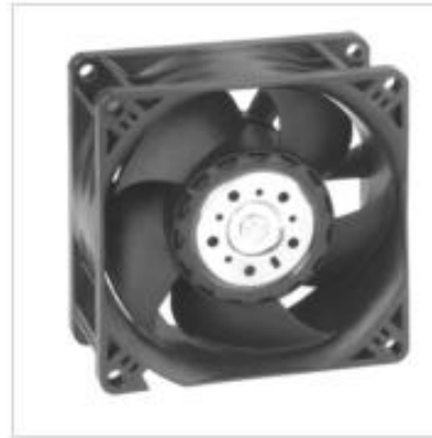
Abb. 13-22 Lüfter führen Wärme von der Heizplatte an die Umgebung ab. Sie ist proportional zur Temperatur-Differenz \Delta T und zur Lüfter-Drehzahl. Diese ist hier durch die Lüfterspannung einstellbar.
