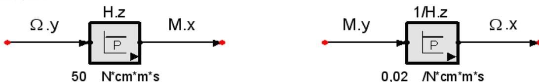
Abb. 4.1.1-4 Der Kiesel als Wandler von Drehzahl in Drehmoment und umgekehrt
